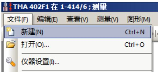
注：此处测试不作标样基线扣除，而使用分析软件中自带的“样品支架”模式对系统膨胀进行修正，故使用“新建”创建新的测量。
