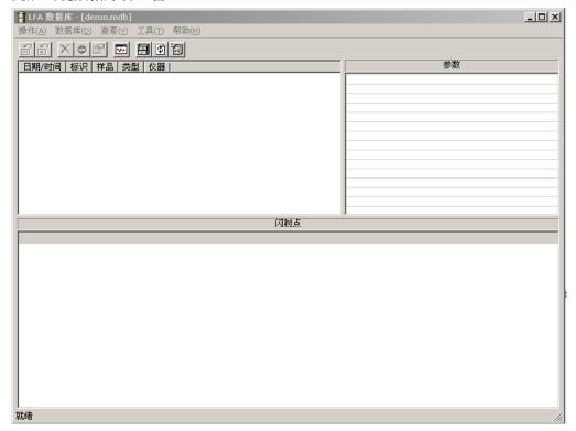
注: LFA Proteus 的数据以 Access 数据库文件(\*.mdb)的形式进行管理。LFA447(Nanoflash)的原始数据文件(\*.dat)需要导入到数据库文件中,一个数据库文件可存放多个测量数据。从数据分类管理的角度出发,一般建议为每一批样品单独创建一个数据库。
