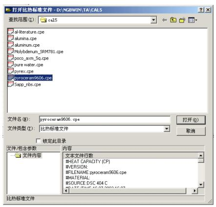
选择相应的 cpe 文件,点击"打开",软件已自动导入 cpe 文件中的比热数据,弹出如下对话框:
