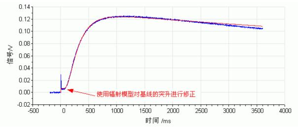
使用辐射模型,对这一类基线的突升进行修正。
