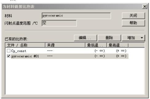
在"已有的比热表"列表中打勾的是当前链接的比热表,保存的是在Nanoflash测量程序中样品定义时输入的Cp值,一般仅为室温下的单点值。因比热是一个随温度而变化的值,需要对其进行重新设定。常用的有如下三种设定方法:
