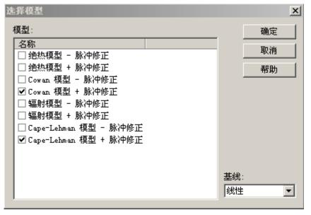
如果一个测量使用了两种以上的模型进行计算,需要选择分析窗口中显示何种模型的计算结果,可点击"测量"菜单下的"选择热扩散系数显示模型":
