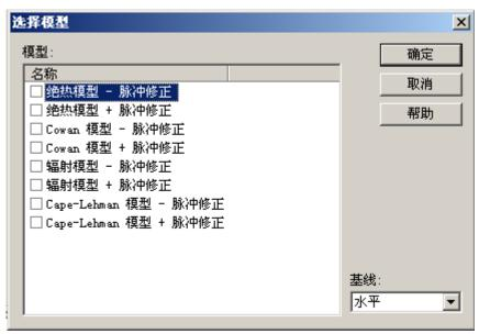
基线类型:推荐使用"线性"(对样品周围环境温度本身的漂移进行修正。前提: Nanoflash 测试程序中"Measurement" → "Parameters"中的 baseline 点数为 300 点以上)
