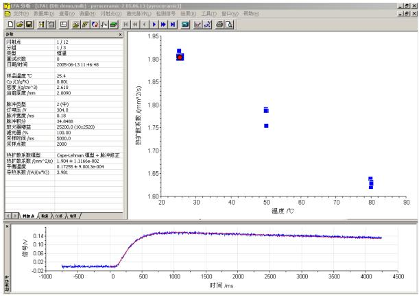
上图的分析界面上有三个小窗口。左上角的小窗口以选项卡的形式显示当前测量文件与所选闪射点的相关信息。右上角的小窗口(结果窗口)显示的是各闪射点计算后的热扩散系数值,其所支持的各项操作大多在"结果"下拉菜单中。下侧的小窗口(检测信号窗口)显示的是当前所选闪射点的原始测量曲线,其所支持的坐标调整、打印等各项操作在"检测信号"菜单中。
