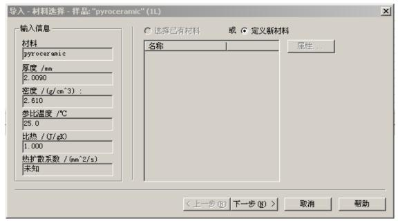
如果在数据库中原已有该材料的信息,只需在材料列表中"选择已有材料"即可;如果是新建的数据库或原数据库中没有该材料的信息,则"定义新材料",点击"下一步",弹出"材料定义"对话框:
