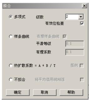
拟合类型有多种,具体选择哪一种合适应视具体测量结果而定。对于大多数样品可选用"多项式",级数选"2"。拟合后的效果如下:
