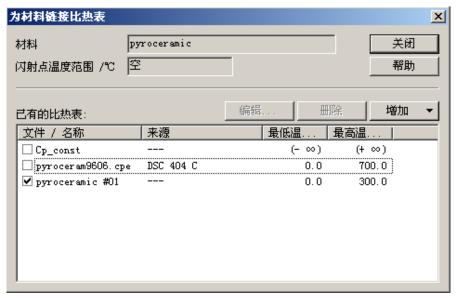
可以看到列表中已多了一个导入的比热表。此时可选中原比热表,点击"删除",再在新增的比热表 左侧打勾,表示把该比热表链接到当前材料的属性定义中:
