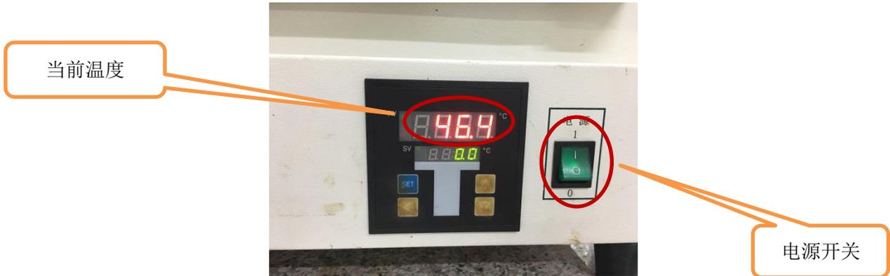
2、将样品放入烘箱，关好烘箱门。注意：炉温 150°C 以上请勿打开烘箱门，50°C 以上取放样品请带好隔热手套。
